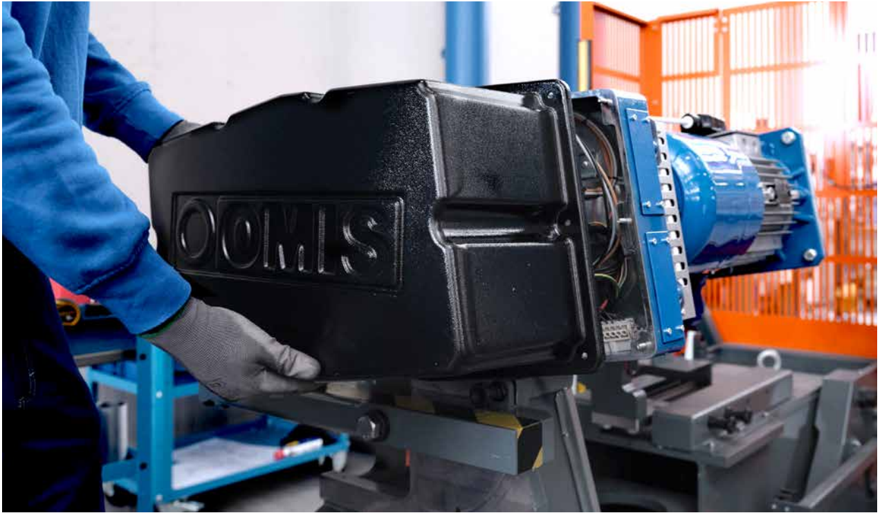
Installation of the electrical panel cover / Montaggio della copertura del quadro elettrico
