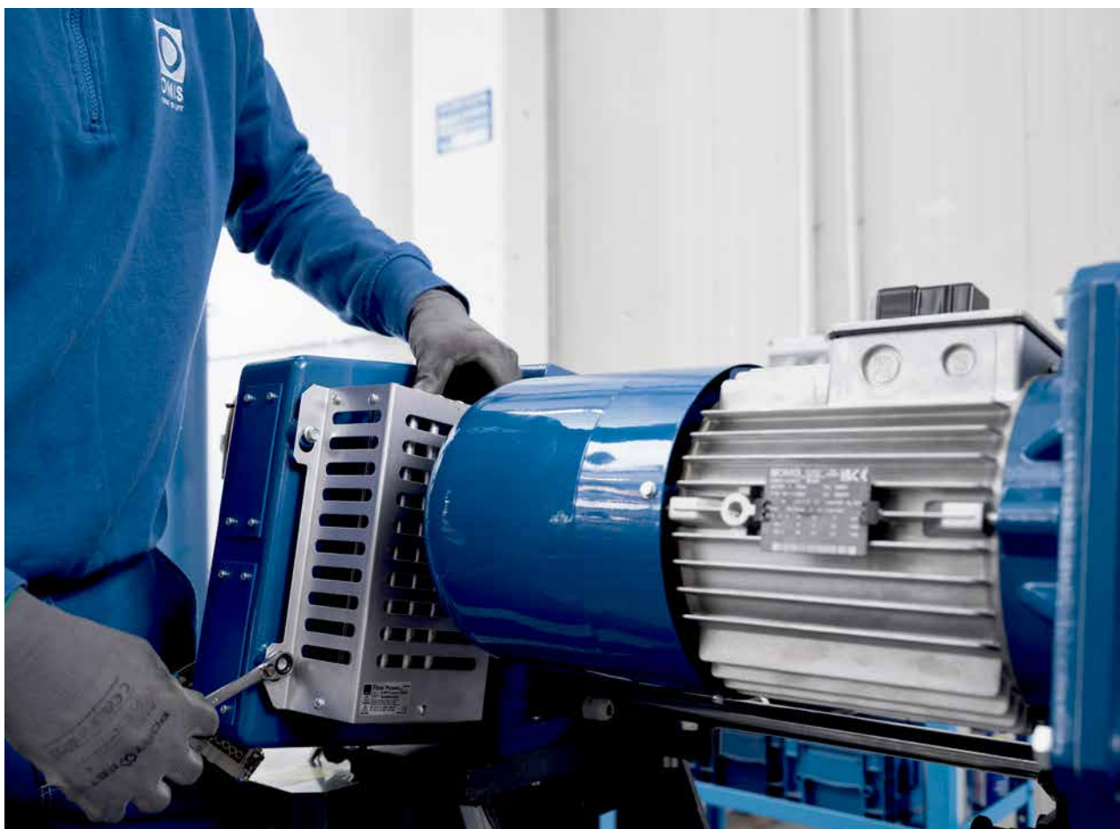
Installing the resistor / Montaggio della resistenza
