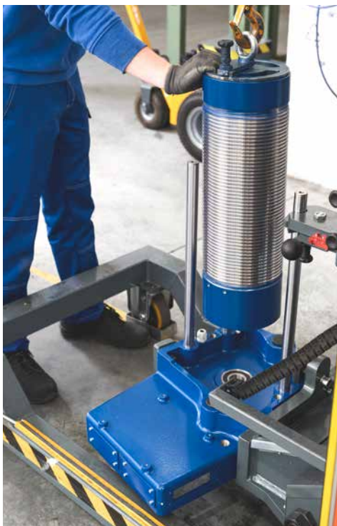
Drum insertion / Inserimento tamburo
