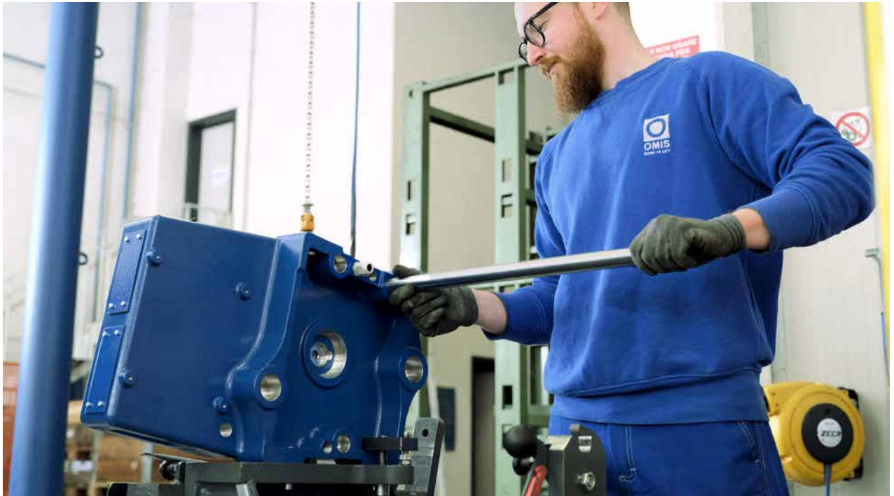
Tie rods assembly / Assemblaggio tiranti
